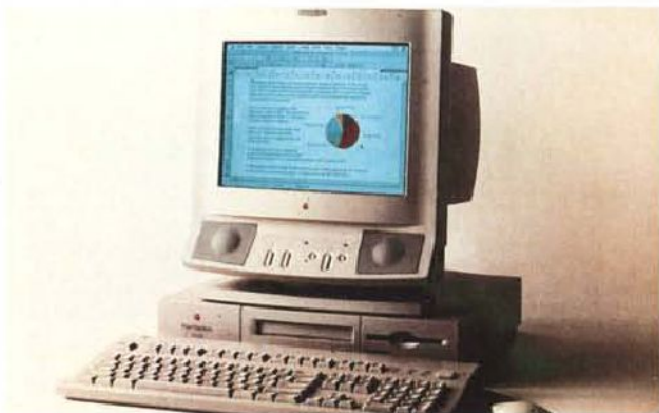
I Power Macintosh del 1995 avranno il clock maggiorato. Anche il modello base, il 6100, monterà il microprocessore PowerPC a 66 MHz.
